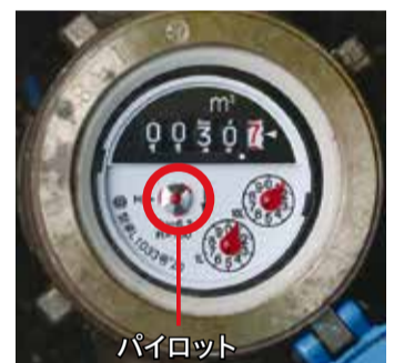
パイロット 蛇口を開けて水道水を使っている間は回転します。
